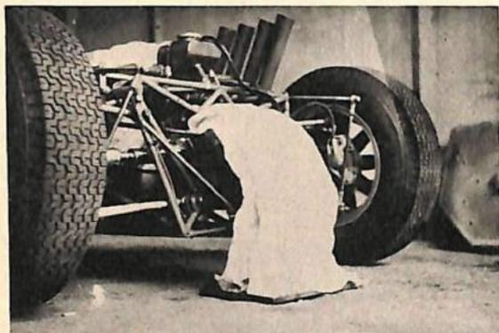
Die vier nach oben ragenden Auspuffrohre sind typisch für den BRM. Die Karosserieteile sind vom Heck abgenommen, und man sieht das Gewirr des Rohrrahmens.
